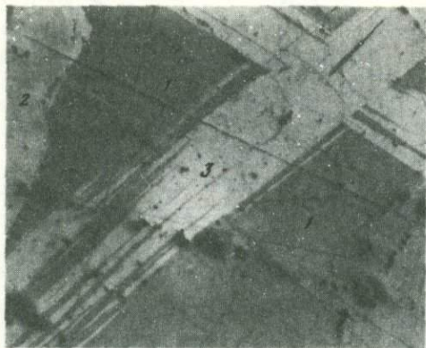
Р и с. 9. Характер срастания халькопирита (1) с моихукитом (2) и кубанитом (3). Октябрьское месторождение
