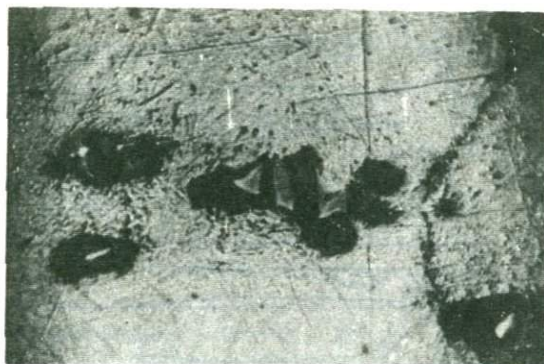
Р и с. 3. Фрактограммы надрезанных образцов сплава ЭП-455А. Увел 50 а – закалка от 1080°C; б – закалка от 1220°C
