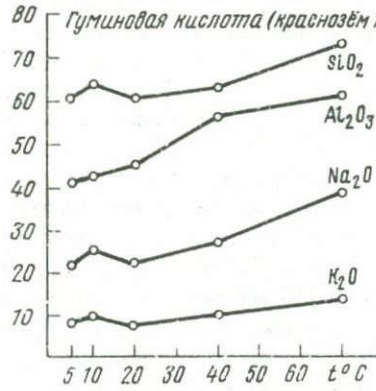
Фиг. 10. Вынос элементов из нефелина в раствор различными кислотами в зависимости от температуры
