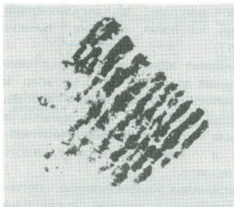
Рис.3. Закалочные структуры в закаленном стекле в системе Ol-Opx-Crx-Gr (иммерсионный препарат, увел. 1000)
