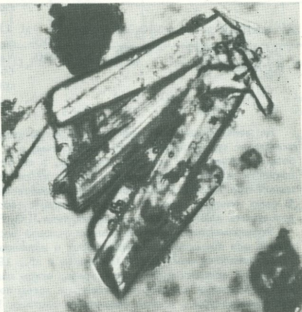
Фиг. 2. Призматические кристаллы гидроксил-апатита, иммерсионный препарат, увел. 60
