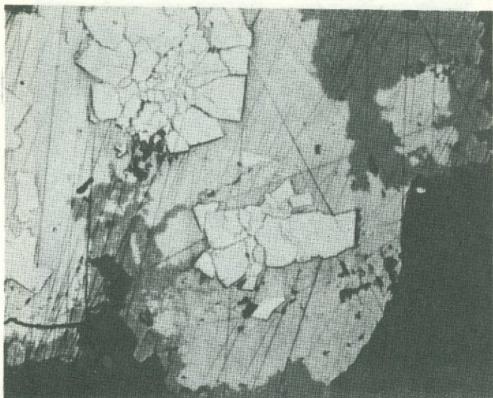
Фиг. 9. Окристаллизация минералов в сложных оолитах. Марказит (белое) наиболее окристаллизован; халькопирит – светло-серое, борнит – темно-серое, черное – цемент. Холодная зона реактора. Полир. шлиф, увел. 200
