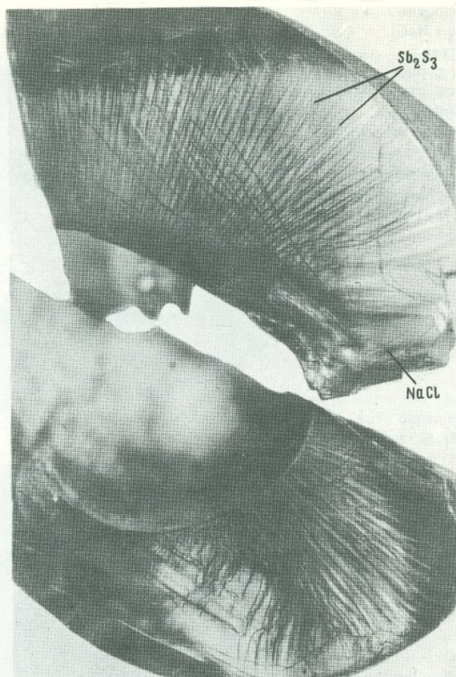
Фиг.5. Волосовидные и цепочечно-капельвидные включения Sb_2S_3 в NaCl Состав: 99,5 мол.% NaCl+0,5 мол.% Sb_2S_3 , увел. 18
