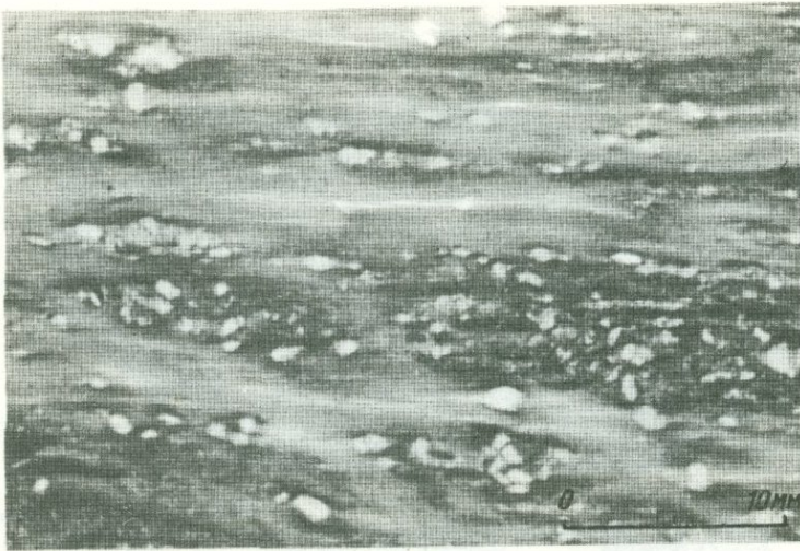
Фиг. 42. Алевролит, подвергшийся кварц-альбитовому метасоматозу. Видны порфиробласты альбита. Полированный образец
