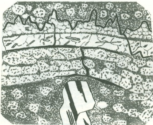
Фиг. 12. Полосчатый кварцевый альбитофир. Микропоякритовые обособления кварца с вростками альбита разделены фельзитовой массой, обогащенной серицитом и гидробиотитом. Видна существенно кварцевая полоса с вростками микролитов альбитизированного калиевого полевого шпата. Черные прожилки — гидробиотит. Увел. 50. Шлиф 644-д
