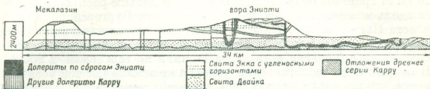
Р и с. 40. Разрез северного угольного бассейна Наталя. (Иллюстрирует внедрение долеритовых силлов Карру путем поднятия кровли; вариант по Блиньо и Фуртеру, 1940.)
