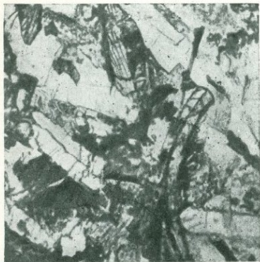
Р и с. 5. Долерит типа горы Даунс, Гангнест (Кальвиния). Простой свет ( \times 13 ). Виден изогнутый кристалл пироксена.
