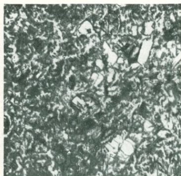
Р и с. 1. Контактный базальт, Тиклоф (Фрезербург). Вкрапленники плагиоклаза и оливина. Простой свет (x 13).
