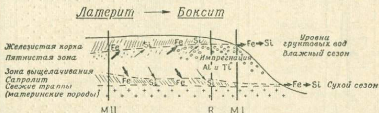
Фиг. 42. Связь вертикальной и боковой фациальной дифференциации латеритов с дренажем, район Халар, Гуджарат, Индия.
