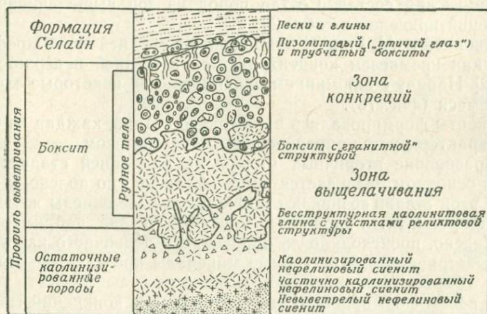
Фиг. 51. Бокситовый профиль на нефелиновых сиенитах Арканзаса, США. Выделяются базальная зона сапролита, нижний бокситовый горизонт с реликтовой структурой и верхняя бокситовая зона с пизолитовой текстурой [97].
