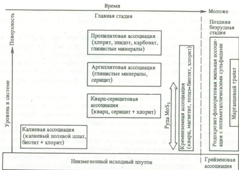
Рис. 14. Схема гранитной молибденитовой системы [Mutschler et al., 1981]
