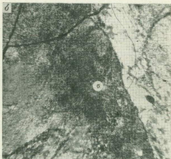
Рис. 54. Текстура польдиевой глины после испытания статическим зондированием в зоне I. а — текстура мозаичная; б — текстура течения. Никели +, ув. 200 X
