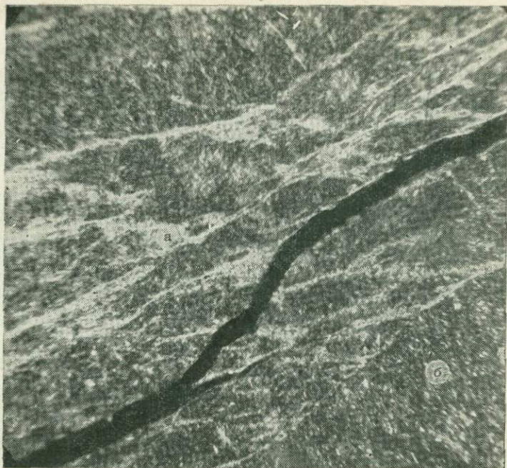
Рис. 29. Зона перестройки текстуры в иольдиевой глине ненарушенного сложения при одноосном сжатии.
