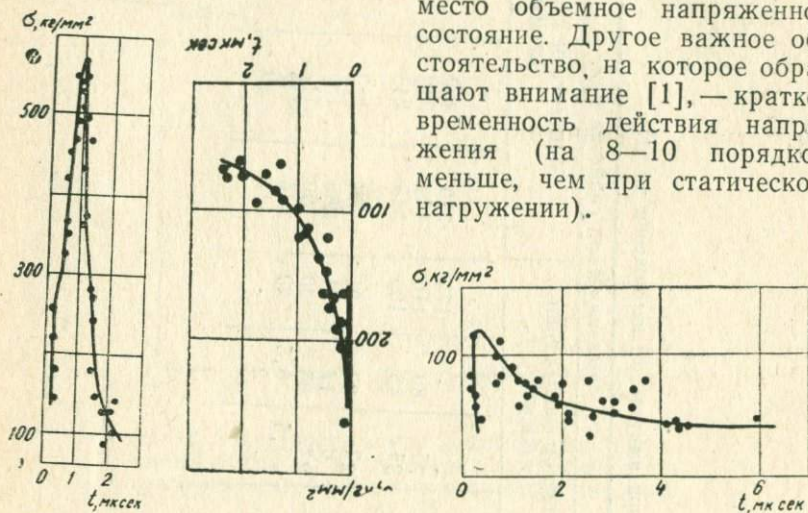
Рис. 6, 7, 8. Зависимость напряжения от времени для стали, алюминия и свинца по [1]
