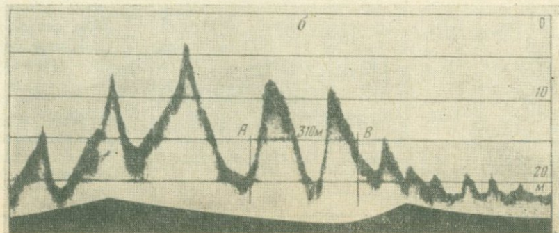
Рис. 2. Эхограммы по продольной оси северной части гряды Варн (а) и поперек гряды Фаллс (б) в южной ее части (Van Veep, 1936); внизу — профили на участках А—В без искажения масштаба; высота крупных продольных волн на гряде б соизмерима с ее высотой
