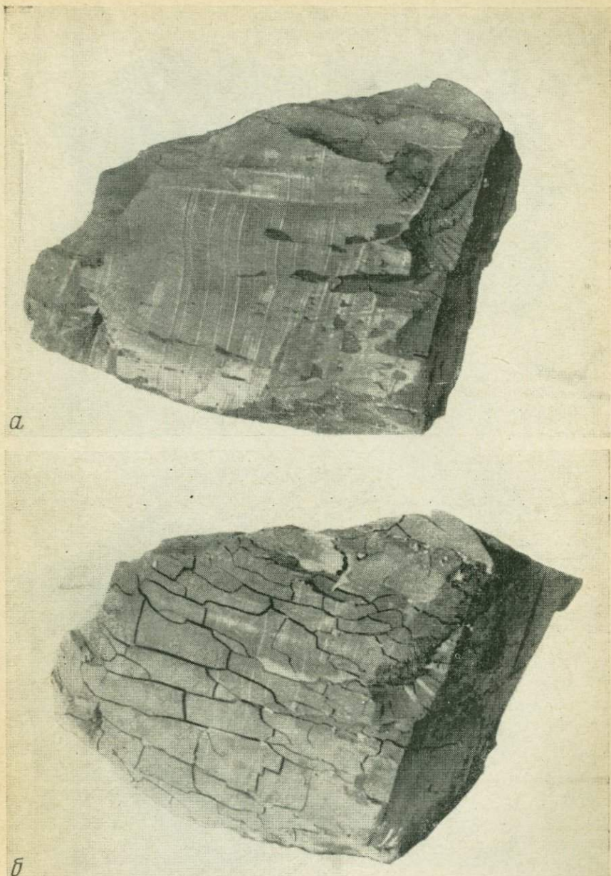
Рис. 22. Опыт по определению интенсивности физического выветривания обнаженной сарматской глины
