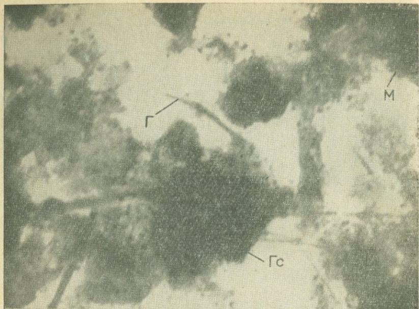
Рис. 2. Контакт алевритистого аргиллита с глинами (остаточная кора выветривания). Обр. 76 — скв. 71 (интервал 37,0—37,8 м), \times 22\ 000 . Полупрозрачные и непрозрачные частицы монтмориллонита (М) с расплывчатыми контурами; удлиненные трубчатые частицы галлуазита (Г); четкие единичные частицы гидрослюды (Гс).
