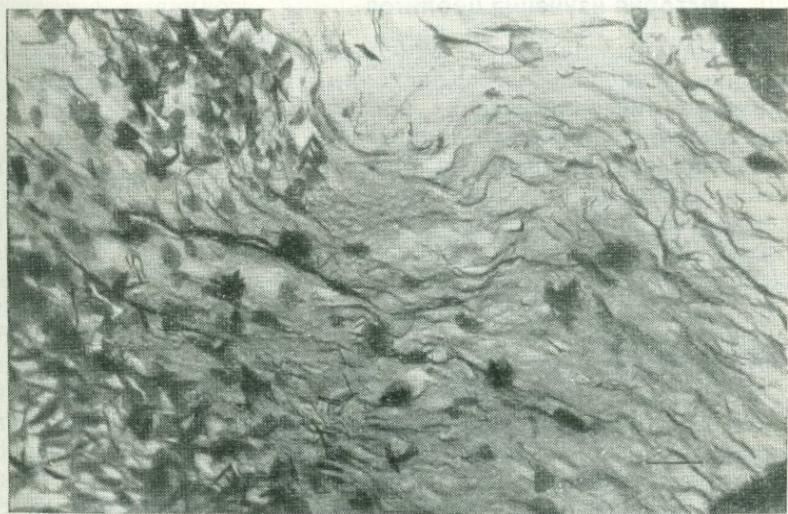
Фиг. 2. Выделение монтмориллонитовых кристаллов в гидратизированном вулканическом стекле. Месторождение Мухор-Тала, северо-западная часть купола. Увел. 11 000, угольная реплика, фото К. Ф. Фроловой и В. В. Наседкина
