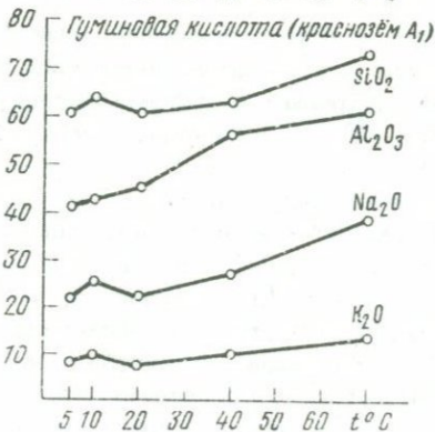
Фиг. 10. Вынос элементов из нефелина в раствор различными кислотами в зависимости от температуры
