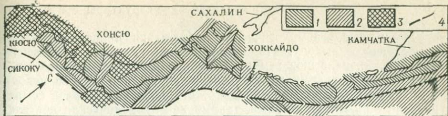
Рис. 74. Напряжения в очагах землетрясений на глубинах до 60 км в северо-западной части Тихоокеанского сейсмического пояса [Аверьянова В. Н., 1972 г.]. Области максимальных напряжений: 1 — горизонтальное сжатие, 2 — горизонтальное растяжение, 3 — сдвиги; 4 — ось глубоководного желоба.
