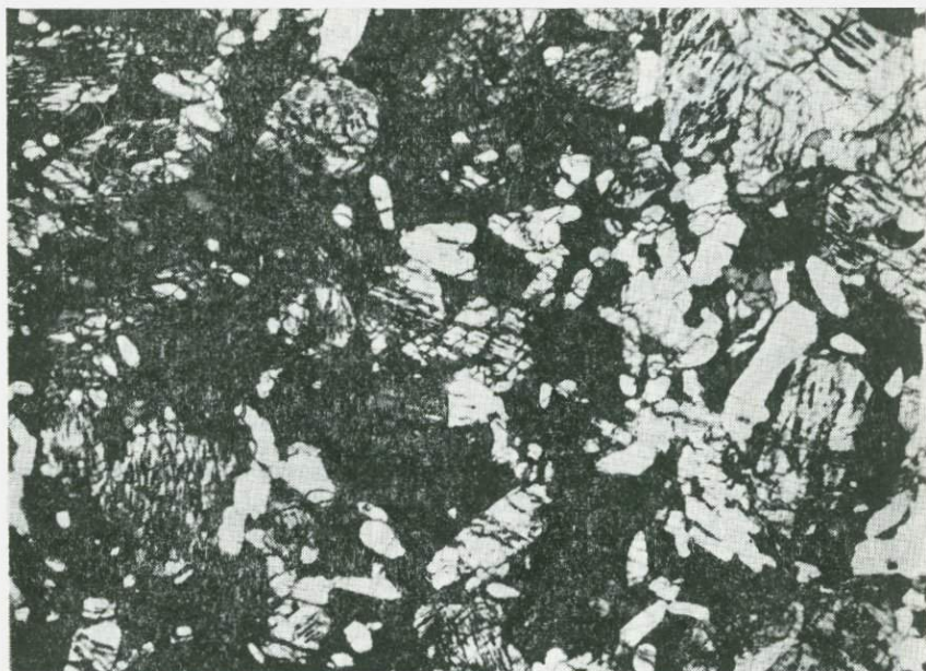
Рис. 2. Рудный пироксенит (обр. Р-983о). Николи ||, Увел. 17. Белое — апатит; черное — ильменит, шпинель; серое — пироксен, роговая обманка; светло-серое — оливин
