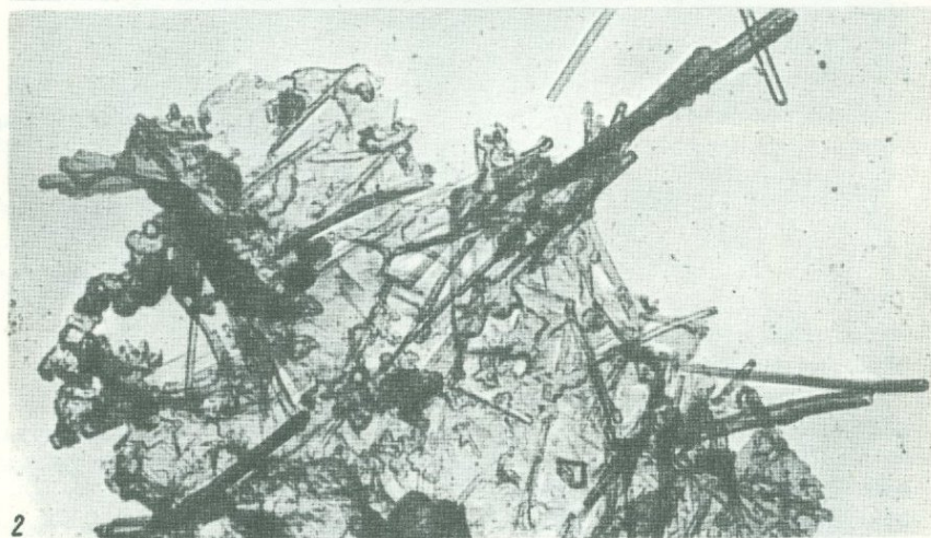
Фиг.7. Выделение антимонита в геле кремнезема, Стимбот Спрингс, угольные реплики:
