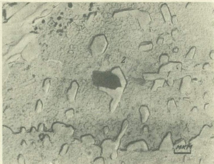
Фиг. 2. Тонкоглобулярная структура вкрапленника; сегрегация глобул (1) в ламели (2)
