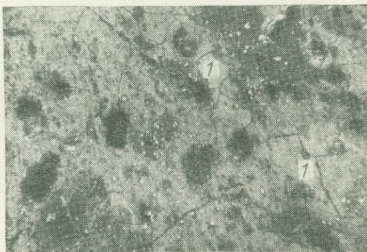
Рис. 45. Характерные структуры браннеритовых руд. Выделения браннерита (1) с тонкой вкрапленностью пирита в цементе брекчий. Полир. шлиф, увел. 70
