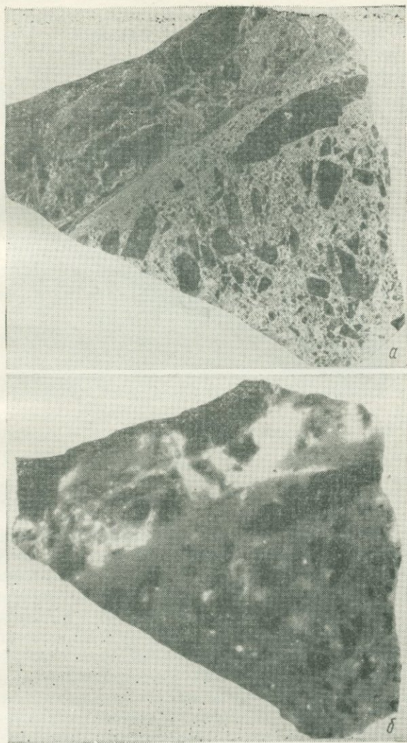
Рис. 44. Характерные текстуры браннеритовых руд. Ураноносные брекчии с обломками барит-кварцевых жил и пирит-карбонат-калишпатовых метасоматитов:
