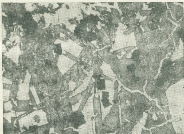
Рис. 82. Характерные структуры редкометалльных руд. Кристаллы лопарита (черное) в малиньите. Серые шестоватые кристаллы — эгирин (фото, проз. шлиф, увел. 15)
