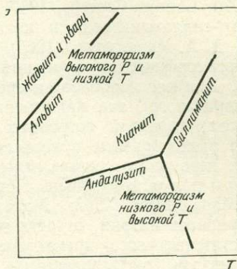
Рис. 4. Соотношение метаморфических комплексов высоких давлений — низких температур и низких давлений — высоких температур (Miyashiro, 1969)
