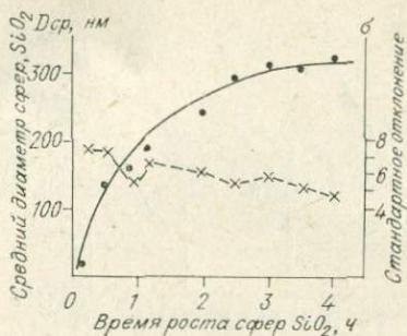
Рис. 25. Зависимость изменения размера частиц кремнезема (сплошная линия) и среднеквадратичного отклонения (штриховая) от времени.
