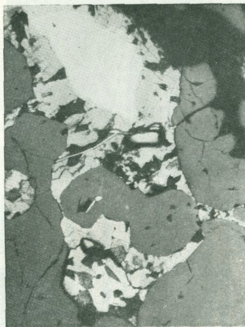
Рис. 69. Купроплатина в виде каймы вокруг центральной непротравившейся части зерна первичной платины (белое). Среди медистой платины наблюдаются непротравившиеся зерна и изогнутые жилкоподобные образования платинистого иридия очень высокой твердости (с резким ореолом). Серое — хромшпинелид; черное в нем — серпентин. Крутой лог. Месторождение № 4—42. Увеличено в 100 раз.
