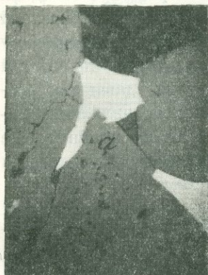
Рис. 78. Замещение платиной (белое) кристаллов хромшпинелида (серое). кристалл a в местах соприкосновения с хлоритом имеет прекрасно выраженные грани в виде прямых линий, которые на границе с платиной приобретают иззубренный характер. Месторождение — Госшахта. Увеличено в 80 раз.
