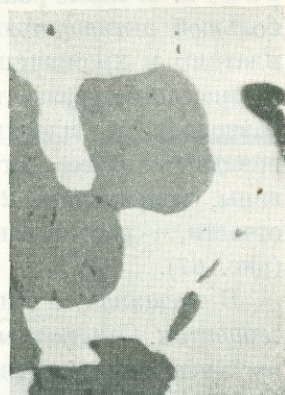
Рис. 80. Коррозия платиной (белое) хромшпинелидовых зерен (серое). На фотографии видно, что замещение следует вдоль границ между отдельными зернами хромшпинелидов. Месторождение — Госшахта. Увеличено в 80 раз.
