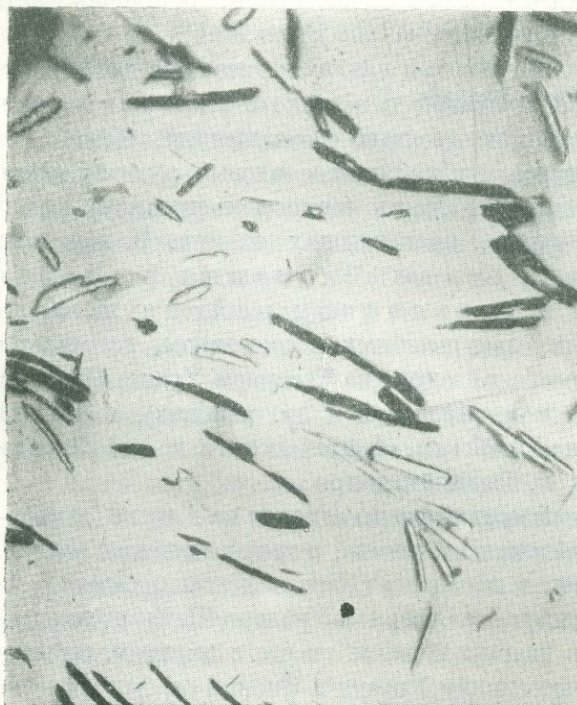
Рис. 30. Осмит (?) (черный) и осмистый иридий (белый с рельефом) в виде пластинчатых кристаллов в самородной платине. Светлосерые неправильной формы зерна в платине (без рельефа) — неизвестный платиновый минерал с твердостью около 4. Кытлымо-Косвинский массив р. Иов. Увеличено в 100 раз.
