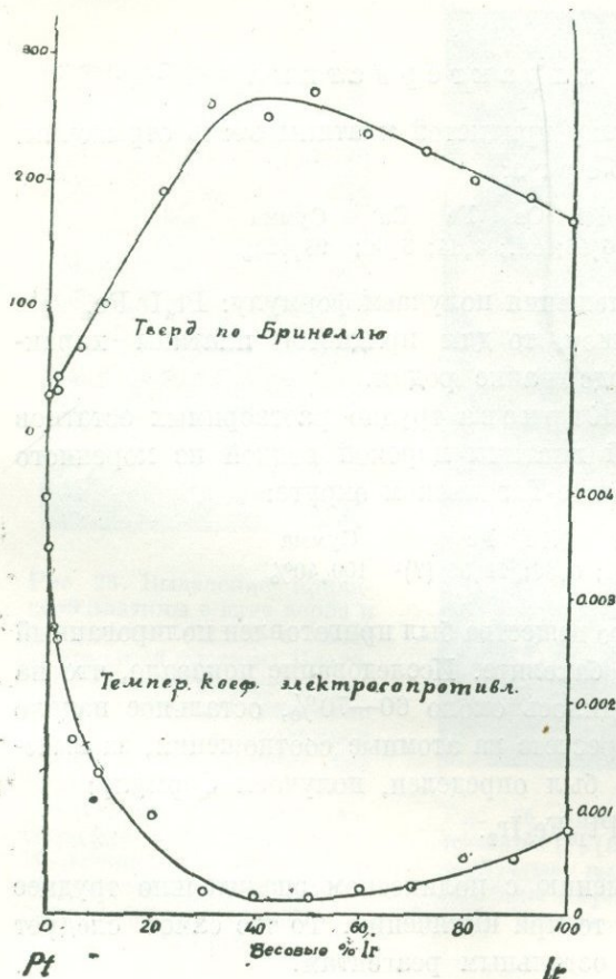
Рис. 27. Кривые твердостей и температурных коэффициентов электросопротивления для системы сплавов платина—иридий.
