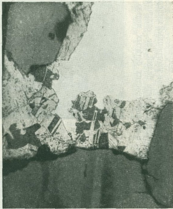
Рис. 50. Подсинтетически двойниковые образования купроплатины, выявляющиеся после протравы царской водкой. Крупные серые зерна по периферии — хромшпинелид. Участок не протравившейся платины (белое с гладкой поверхностью) — первичная платина. Месторождение № 4—42 в Крутом логу Нижне-Тагильского дунитового массива. Полированный шлиф. Увеличено в 110 раз.
