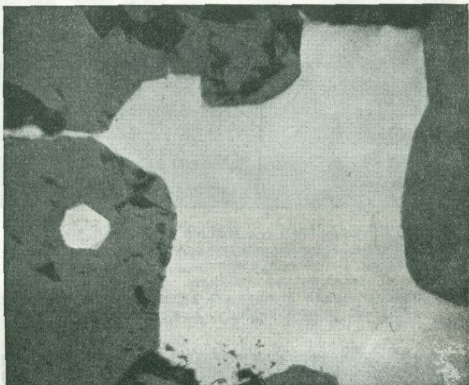
Рис. 4. Кристаллик платины (белый многоугольник слева) в хромшпинелиде (серое). Черное — серпентин и пустоты. Полированный шлиф. Нижне-Тагильский унитовый массив. Месторождение № 4—02 (в Крутом логу). Увеличено в 100 раз.
