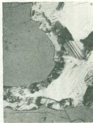
Рис. 70. Образование купроплатины в виде каймы по периферии выделений платины. Хорошо видны полисинтетически - двойниковые образования. В самих ядрах сохранившейся первичной платины произошло также замещение вдоль направлений спайности в виде тонких закономерно расположенных пластинок. Крутой лог. Месторождение № 4—42. Увеличено в 100 раз.
