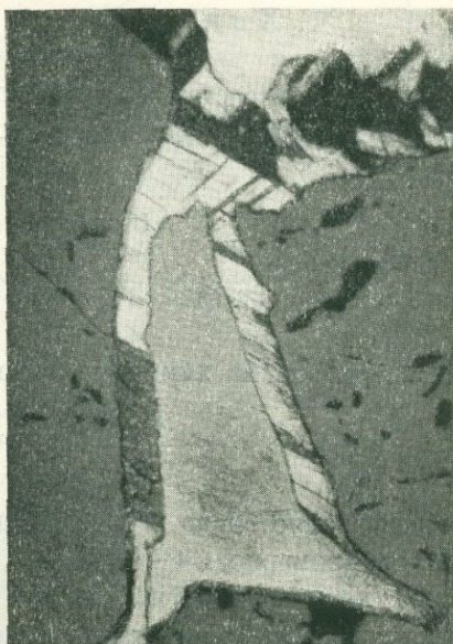
Рис. 56. Каемки никелистой платины с полисинтетически двойниковым строением. Темные участки среди них — купроплатина. Серый окружающий фон — хромшпинелид. Центральная часть зерна — первичная платина; обнаруживает так называемую спайность травления (закономерно расположенные штрихи). Протравлено смесью \text{HCl} + \text{CrO}_3 (50%). Месторождение — «Госшахта». Увеличено в 180 раз.
