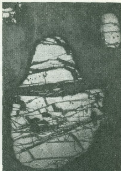
Рис. 67. Зерно хромшпинелида (белое), разбитое сетью параллельных трещин, выполненных серпентином (темносерое). Крутой лог. Месторождение № 4—41. Увеличено в 80 раз.
