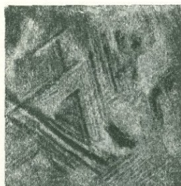
Рис. 20. Микроструктура сплава платины с железом (48,68 ат. % Pt), отожженного при температуре 680°. Увеличено в 55 раз.
