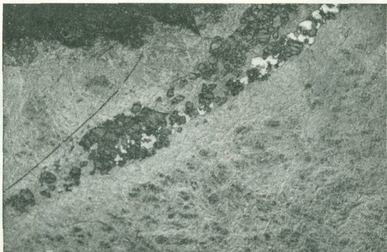
Рис. 74. «Цепочка» зерен платины (белое) и в прожилке хромшпинелида. Окружающий фон — серпентинизированный дунит. Полированный штаф. Месторождение № 3—02 в Сырковом логу. Увеличено в 5 раз.
