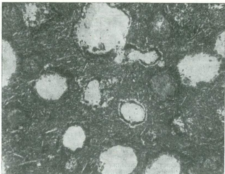
Фиг. 6. Миндалекаменный пикрит-базальт. Свита мтавари. Западная Грузия. Шлиф, увел. 45, без анализатора
