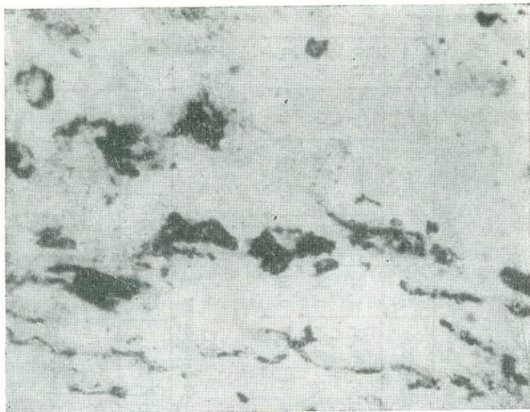
Фиг. 57. Темные фосфатные образования в песчанике. Нижний кембрий. Казахстан. Шлиф, увел. 30, без анализатора
