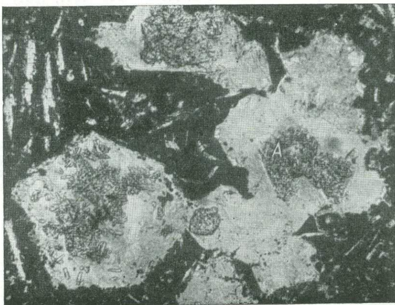
Фиг. 12. Кристаллы апатита (А), образовавшиеся в результате автометасоматоза в хлорит-серпентиновых псевдоморфозах по оливины в пикрит-базальте. Свита мтавари. Шлиф, увел. 140, без анализатора
