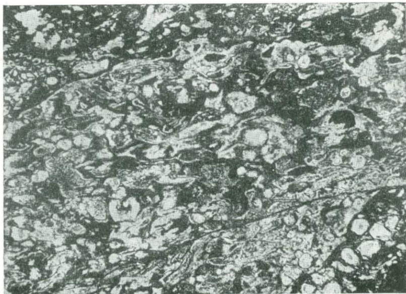
Фиг. 67. Пенистые лавы. Приохотье. Шлиф, увел. 40, без анализатора
