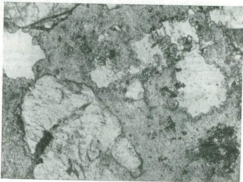
Фиг. 21. Фосфорит чайской свиты. Прибайкалье. Шлиф, увел. 70, без анализатора
