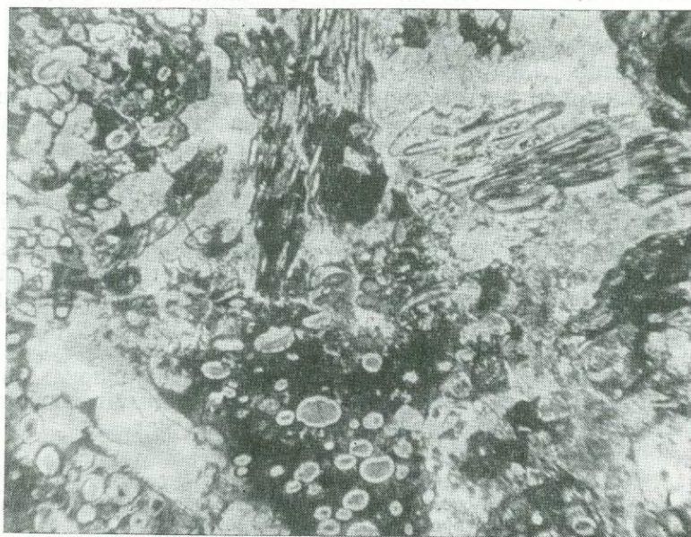
Фиг. 8. Шлаковый туф. Видна причудливая форма ювенильных обломков. Цемент кальцитовый. Свита мтавари, Западная Грузия. Шлиф, увел. 45, без анализатора
