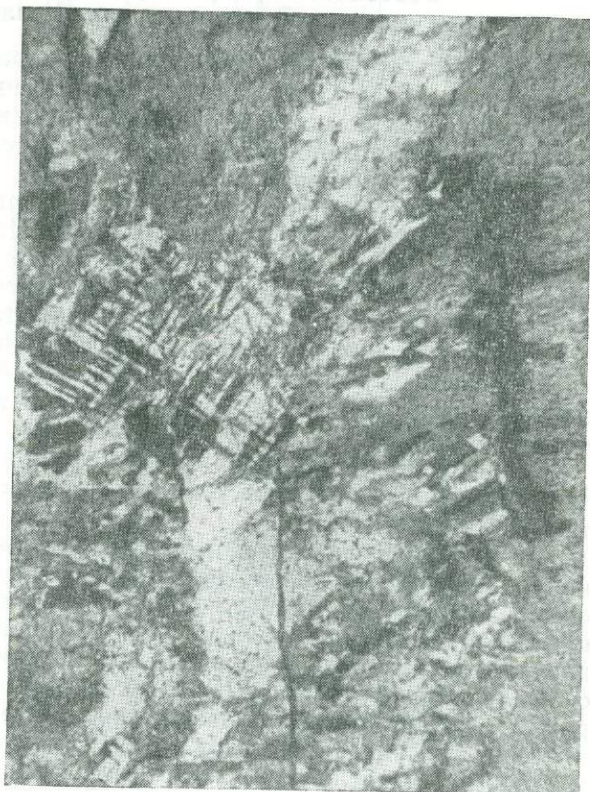
Фиг. 21. Фосфорит чайской свиты. Прибайкалье. Шлиф, увел. 70, без анализатора
