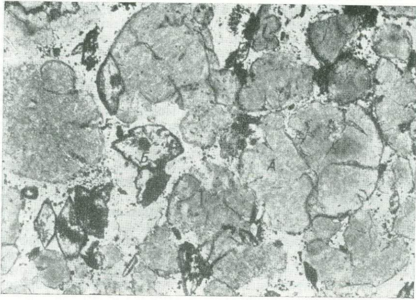
Фиг. 29. Глауконит (А) и сидерит (Б) из зоны фосфатизации. Миоцен. Сахалин. Шлиф, увел. 80, без анализатора
