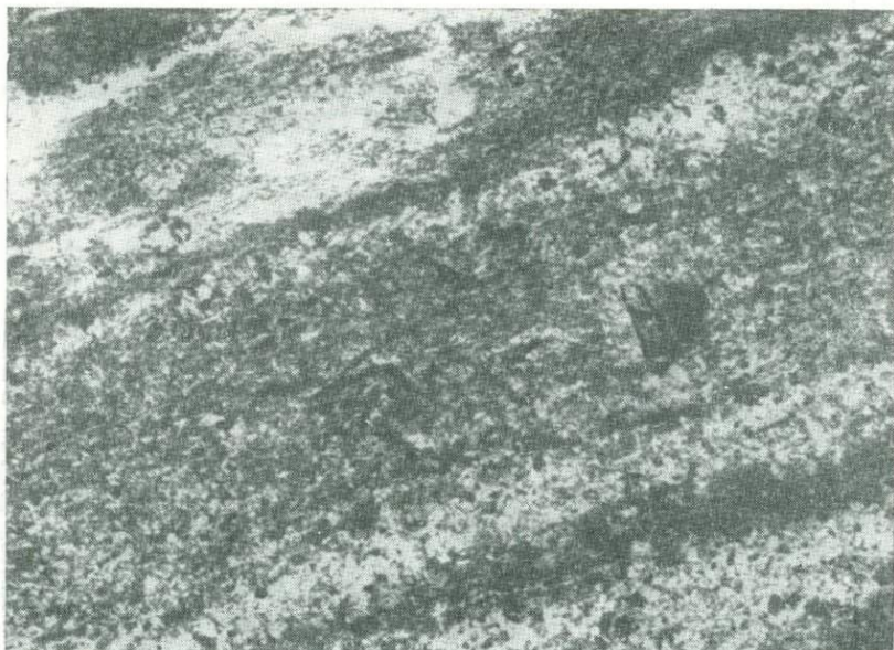
Фиг. 76. Фосфатизированный пепловый туф. Верхний мел. Польша Шлиф, увел. 70, без анализатора
