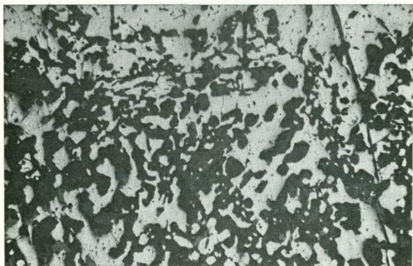
Рис. 70. Эвтектоидные срастания магнетита (светлое) с калиевым полевым шпатом (темное) в контакте сенинтовой дайки с магнетитовой рудой. Ирбинское железорудное месторождение. Полированный шлиф. Увел. 80.
