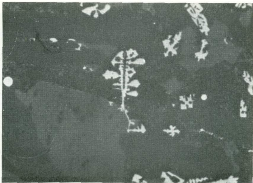
Рис. 30. Скелетные кристаллы магнетита (светло-серое) и сульфидные выделения (белые шарики) в основной массе базальта. Стекловатый базальт со дна Индийского океана. Полированный шлиф. Увел. 1000.
