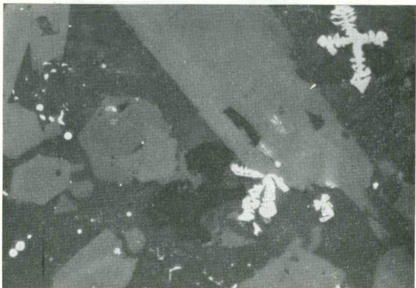
Рис. 31. Скелетные кристаллы магнетита (светло-серое) и сульфидные шарики в глубоководном базальте со дна Тихого океана. Полированный шлиф. Увел. 1000.
