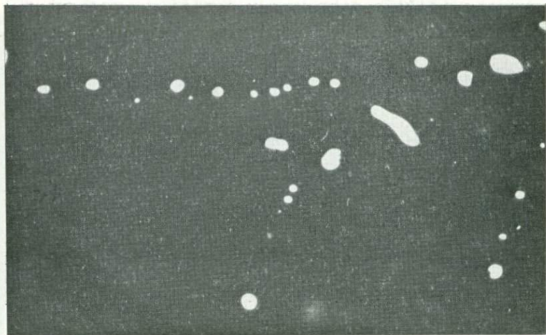
Рис. 13. Коалесценция сульфидных включений в оливине. Шпинелевый лерцолит в базальте. Полированный шлиф. Увел. 800.
