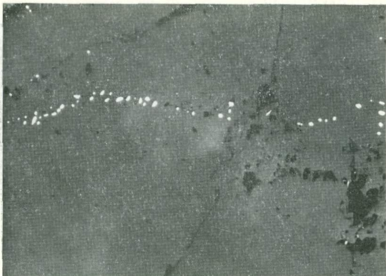
Рис. 3. Цепочковидное расположение сульфидных капель в лерцолите. Свягинская сопка. Полированный шлиф. Увел. 450.
