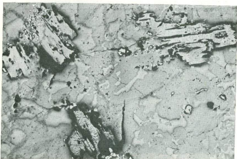
Рис. 74. «Сыпь» мартита (светлое) по краям пластинок измененного биотита. Гранит, Горная Шория. Полированный шлиф. Увел. 50.
