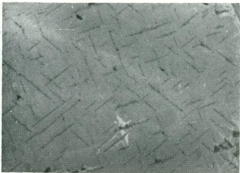
Рис. 49. Титаномагнетит с продуктами распада твердого раствора. Пластинки ильменита сопровождаются тончайшими выделениями шпинели (черное). Полированный шлиф. Увел. 800.
