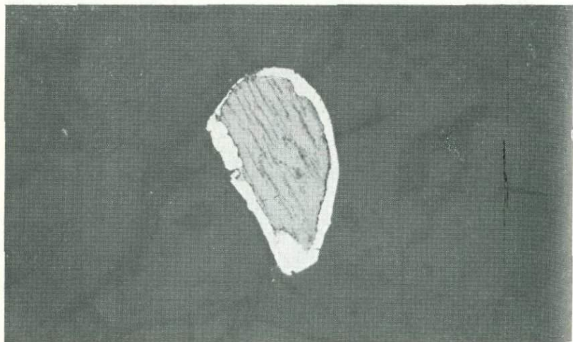
Рис. 20. Халькопирит-пентландитовый агрегат. В центре (серое) — пентландит с выделением по трещинам спайности (темное) маккинавита. По краям — светлая кайма — халькопирит. Полированный шлиф. Увел. 120.
