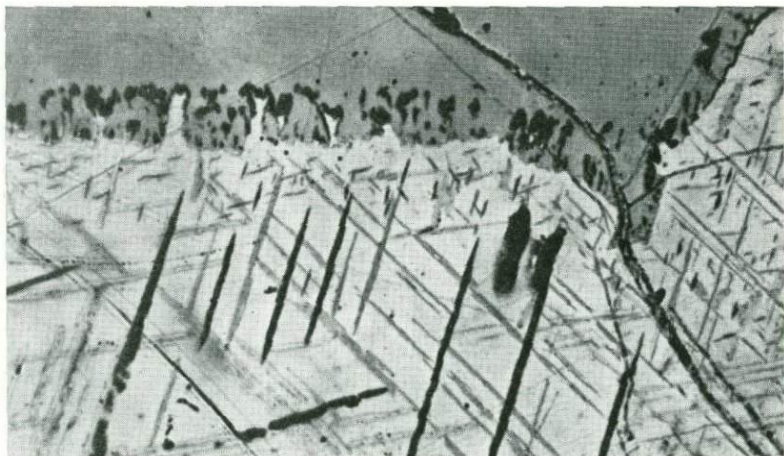
Рис. 64. Титаномагнетит, габбро Большого Таскыльского массива. В нижней части снимка — титаномагнетит с вростками шпиннели (черное) и ильменита (серое); в верхней части — зерно ильменита. В контакте ильменита с титаномагнетитом наблюдаются новообразования шпиннели (черное) и остаточные зерна магнетита (светлое). Полированный шлиф. Увел. 500.
