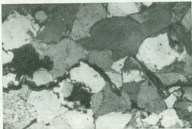
Рис. 9. Микростилолитовая поверхность растворения, сескующая ранее сформированную конформно-регенерационную структуру. Ник. +, увел. 64
