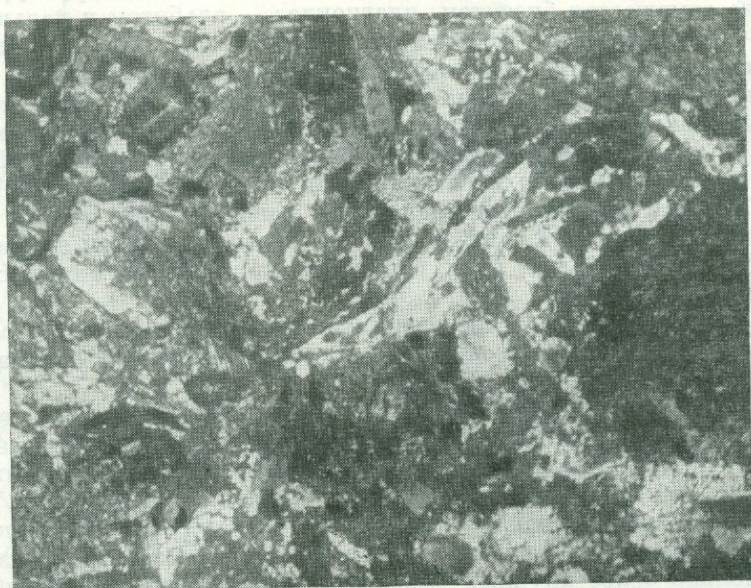
Рис. 4. Амфиболит с бластоофитовой структурой. Оленегорское месторождение. С анализ., увел. 35
