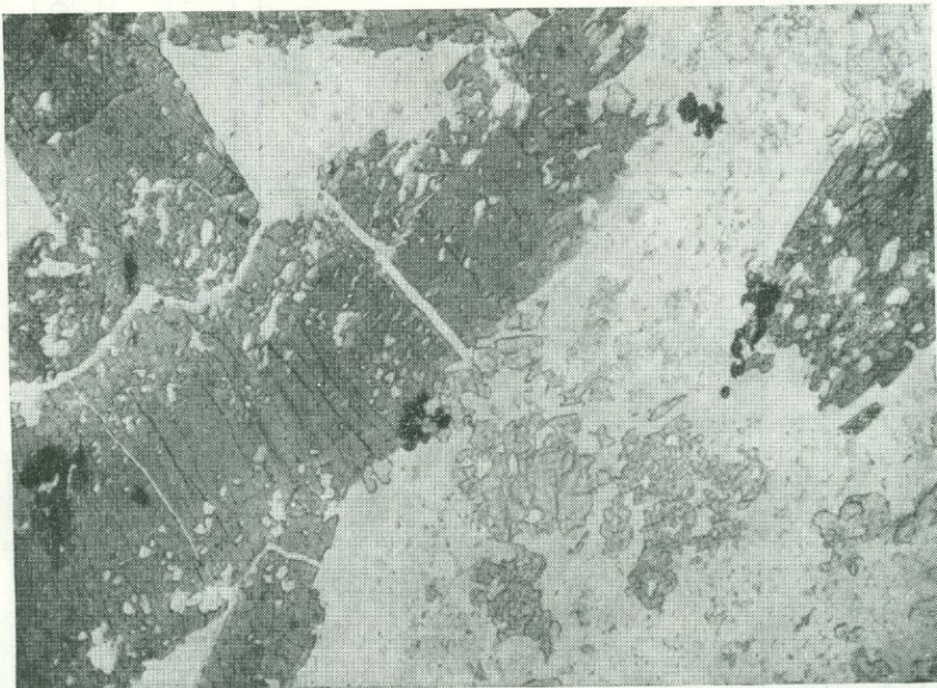
Рис. 5. Пойкилобластическая структура анкеритового амфиболита. Без анализатора, увел. 20
