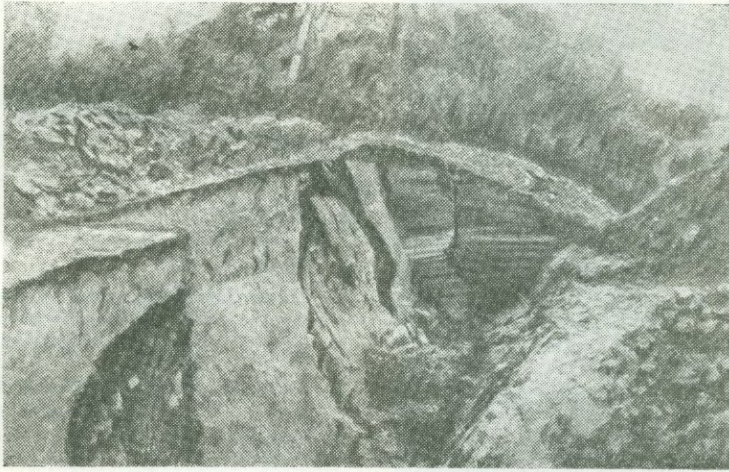
Рис. 168. Опытный участок. Последующий момент. Резкая деформация откоса как следствие выноса из его основания песка.
