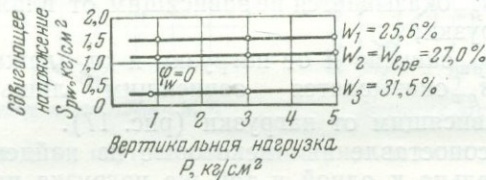
Рис. 17. Глинистый грунт. Сопротивление сдвигу зависит лишь от плотности породы и не зависит от нагрузки. Во всех случаях \varphi_w = 0 . Делювий Юрюзани.
