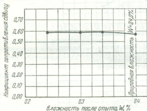
Рис. 27. Зависимость F_p = f(w) . Зависимость выражена очень слабо. Межморенные суглинки. Структура ненарушенная.
