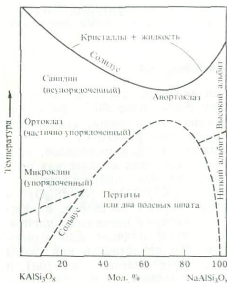
Рис. 2-1. Номенклатура и области термической устойчивости щелочных полевых шпатов от температур солидуса до 400 °С. Границы фаз проведены схематически. Линия солидуса соответствует давлениям, характерным для вулканических и субвулканических условий.
