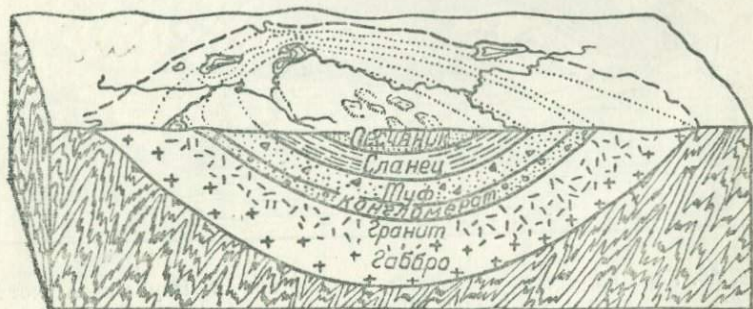
Рис. 54. Поперечный разрез и план затухающей мульды.
