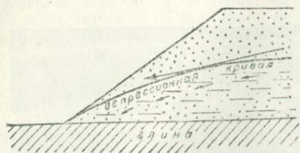
Рис. 229. Давление фильтрующегося потока на откос канала до наполнения его водой.
