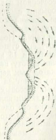
Рис. 228. Деформации поперечного сечения канала в результате оползня, сопровождающегося выпиранием дна.
