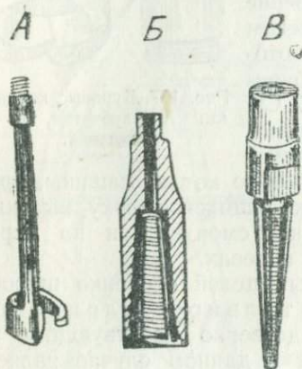
Рис. 179. Ловильный инструмент: А — счастливый крючок, Б — колокол, В — метчик.
