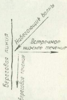
Рис. 110. Схема образования встречного нижнего и берегового течений.
