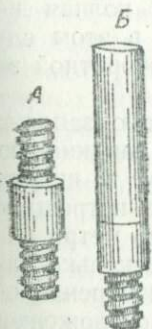
Рис. 178. Ниппель (А) и отрезок штанги с ниппелем (Б).
