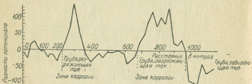
Рис. 261. Исследование коррозии трубопровода в Cormeilles (Париж).
