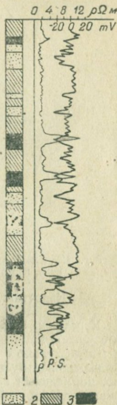
Рис. 132. Диаграмма \rho и P.S. нефтяной скважины. 1 — водные пески; 2 — глины; 3 — нефтяные пески.
