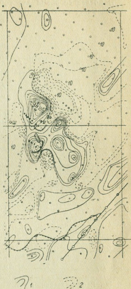
Рис. 194. Магнитные аномалии над магнетитсодержащей железной шляпой. Смирновское месторождение, Серный рудник.
