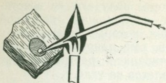
Рис. 4. Положение пластинки древесного угля и паяльной трубки при прокаливании
