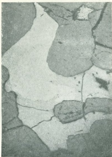
Фиг. 10. Платина (белое) и сульфид меди (светлосерое) в виде ксеноморфных выделений в хромшпинелидовом агрегате (серое). Крутой лог. Месторождение № 4—02. \times 9 .
