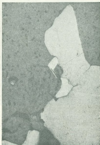
Фиг. 9. Кристаллики платинистого иридия (?) в полиарсене. Протравлено концентрированной царской водкой. Темносерое — хромшпинелид. Нижне-Тагильский дунитовый массив. Госшахта. \times 90 .
