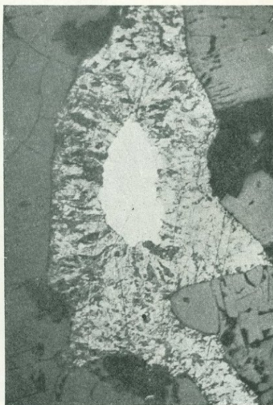
Фиг. 12. Строение купроплатины, выявившееся после травления в парах царской водки. В центре — ядро уцелевшей от метаморфизма первичной платины (белое). Окружающий фон — агрегат хромшпинелидовых зерен. Нижне-Тагильский дунитовый массив. Месторождение № 4—00 в Крутом логу. \times 110 .
