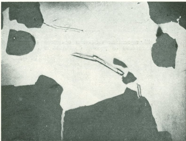
Фиг. 6. «Полые» внутри пластинки осмистого иридия, выделяющиеся на фоне самородной платины (белое) благодаря их высокой твердости. Темное — хромшпинелид. Месторождение № 28 в Александровском логу Нижне-Тагильского дунитового массива. \times 120 .
