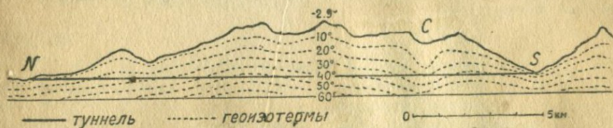
Рис. 5. Геозотермы по профилю Симплонского туннеля.
