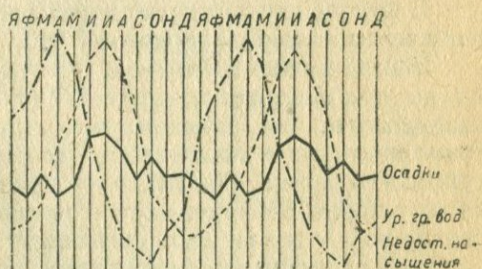
Рис. 146. Двухгодичный период колебания уровня грунтовых вод, осадков и недостатка насыщения для Берлина (из Кейльгака).
