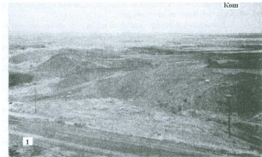
Рис. 1.40. Карьер механической распиловки туфа на южном склоне массива г.Арагац. Кош. Внутрикатьерные отвалы.
