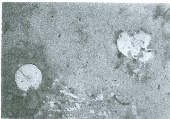
Рис. III.11. Трещиноватые сфероиды настурана в железном микрокварците. Аншлиф. Ув.х400.
