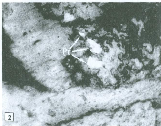
Рис. 1.70. Вкрапленники самородной платины в цементе красных конглобрекций норраревикской свиты. Сварной аншлиф, ув. x250
