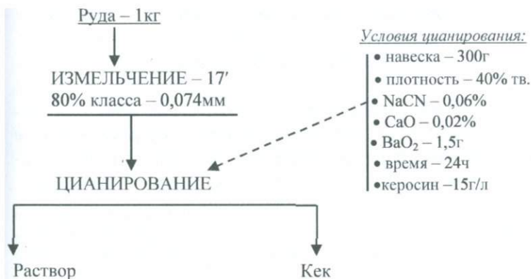
Рис. 1.22. Схема цианирования углесланцев.
