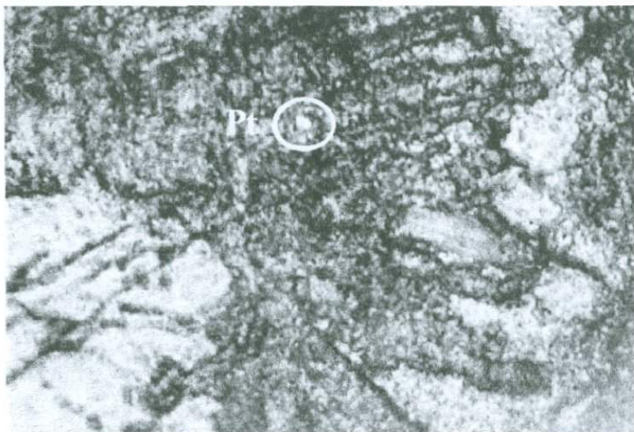
Рис. 1.76. Тапасар. Самородная платина (белое пятно наверху) в основной массе (черное), цементирующей раздробленные зерна хромита (светло-серое). Полированный шлиф Тап-8. Ув. \times 250 . Пл. 3456, к.24.
