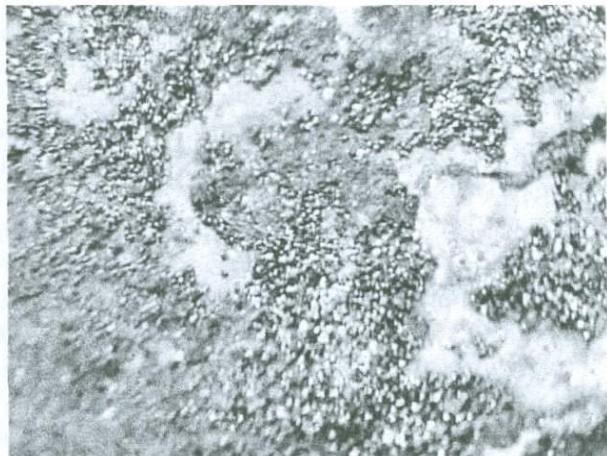
Рис. III.2. Формы выделения урановых минералов во вторичных кварцитах. Мелкие кристаллики и шарики урановых минералов в алунизированной породе. Штуф. Бинокулярная лупа. Ув. х25.
