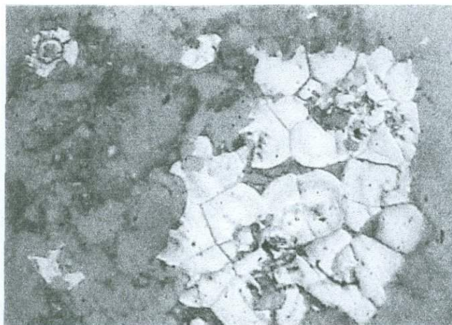
Рис. III.10. Сферонды (шарики) настурана со структурой «разбитой тарелки» в кварците. Аншлиф. Ув.х400.
