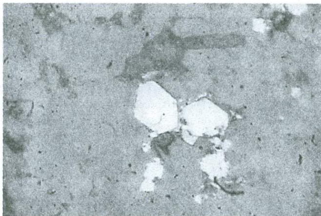
Рис. III.12. Кристаллические индивиды настурана со сглаженными и ровными контурами в кварците. Аншлиф. Ув. x400.
