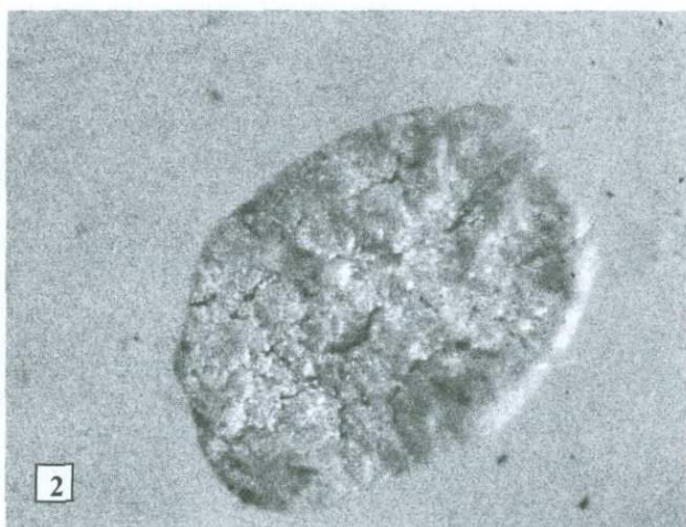
Рис. 1.32. Нор-Аревик. Корольки золота и серебра от металлургической переработки гравиконцентрата угля. Проба ПП-1-758-Гр.
