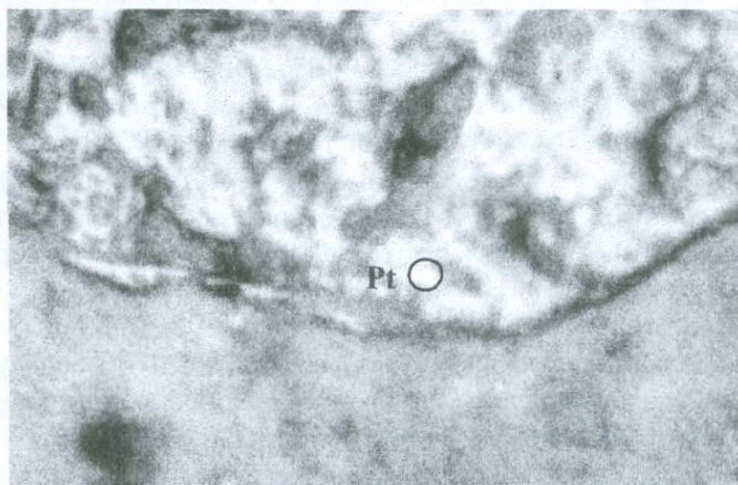
Рис. 1.73. Тапасар. Самородная платина (белое в центре) в хромите (светло-серое). Полированный шлиф Тап-8. Ув. \times 400 . Пл. 3456, к.19.
