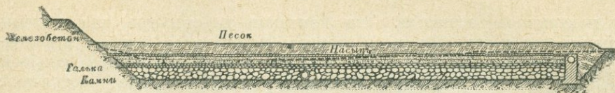
Рис. 127. Поперечный разрез через каптаж источника близ Ранны.
