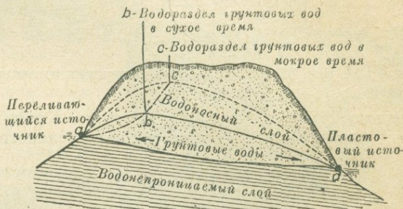
Рис. 55. Переливающийся и пластовый источники (по Голлер-Реутеру).
