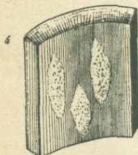
4 Колодезная труба из свежего волокнистого дерева покрытая плесенью гриба Sphaerotilus
