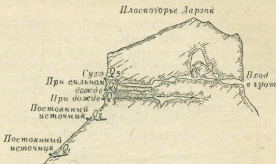
Рис. 71. Разрез через Бундулау (Авейрон) с пятью выходами источников (по Мартелю).
