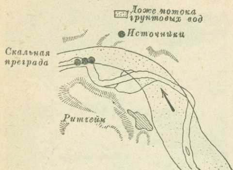
Рис. 40. Возникновение источников близ Ритгейма вследствие пережима водоносного пласта (по Гугу).
