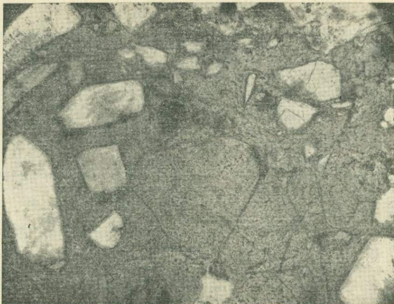
Рис. 20. Реликты пещловой структуры в основной массе игнимбрита под микроскопом; \times 30 , без анализатора, юг Камчатки
