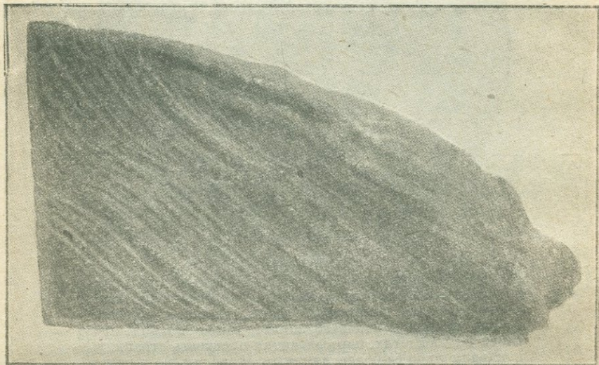
Рис. 54. Деталь плоскости кливажа разлома. Здесь в одних слоях виден совершенный разлом, в других — скорее течение. Вторичные образования слюды параллельны разломам. Темные полосы изображают напластование. (По Риттчеру). Кварциты Барабу.
