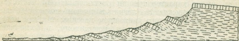
Рис. 81. Схематический профиль через оползни северной окраины горы Lookout, штат Вашингтон. (По Расселю).
