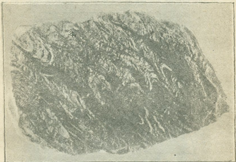
Рис. 56. Кливаж скольжения в гнейсе из южных Аппалачей. Гнейс сильно сгофрирован, и видно, как микроскладки переходят в микросбросы, которые представляют плоскости кливажа разлома. Сбросы, вероятно, цементированы или уплотнены сильным давлением. Параллельно сбросам образуется также параллельное расположение частиц минералов, может быть, отчасти обязанное происхождением скольжения вдоль плоскостей сброса; здесь чрезвычайно трудно отличить кливаж разлома от кливажа течения. („Bull.“ 239, U. S. Geol. Survey).
