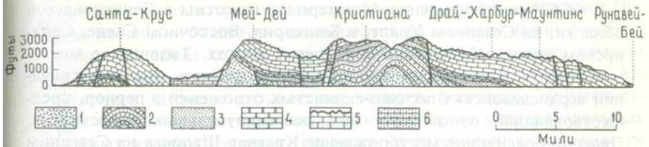
РИС. 68. Схематический разрез через центральную часть Ямайки с месторождениями бокситов средиземноморского типа. Вертикальный масштаб увеличен в 7 раз (по Цансу, 1952, см. в [141]). 1 — андезитовые порфиры; 2 — глинистые сланцы, конгломераты, рудистовые известняки (верхний мел); 3 — туфы, туффиты и конгломераты (нижний эоцен?); 4 — желтые известняки (средний эоцен); 5 — белые известняки с бокситом (средний эоцен — нижний миоцен); 6 — формация литоральных отложений (посленижнемиоценовая).
