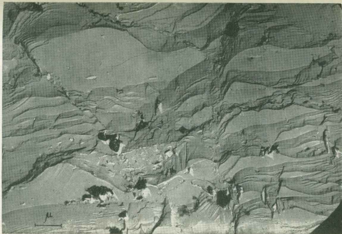
Рис. 6. Ступенчато-раковистый излом настурана. Электронномикроскопическое фото, увел. 11 000
