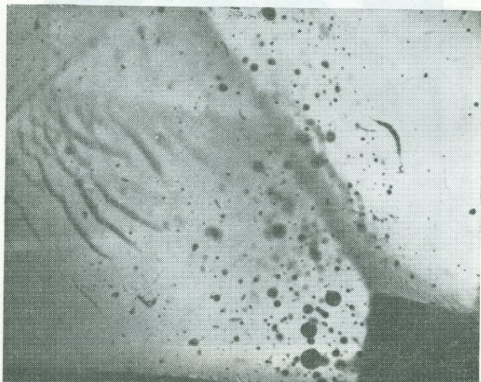
РИС. 7.8. Пузырьки и поверхностные трещины в синтетическом рубине.
