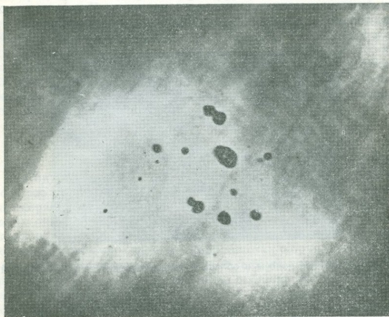
РИС. 7.14. Синтетическая шпинель между скрещенными поляроидами; видны «муар» и пузырьки.
