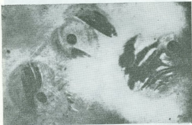
РИС. 11.7. Наиболее характерные включения в сиамском рубине: непрозрачные кристаллы, окруженные заполненными жидкостью трещинами.
