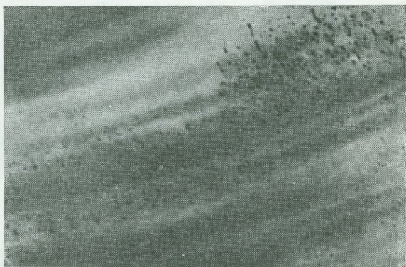
РИС. 7.13. Изогнутые полосы и облака пузырьков в синтетической красной шпинели.
