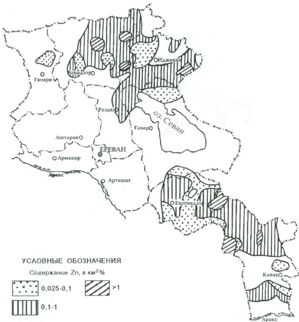
Рис. 3.4. Специализированная геохимическая карта содержания цинка на территории Армении.
