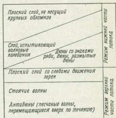
РИС. 3.13. Интерпретация турбидитного цикла Боумы как комплекса отложенных замирающего потока [490]. (См. также: А. Н. Bouma, Sedimentology of some flysch deposits: a graphic approach to facies interpretation, Amsterdam, Elsevier, 1962, 168 p.)
