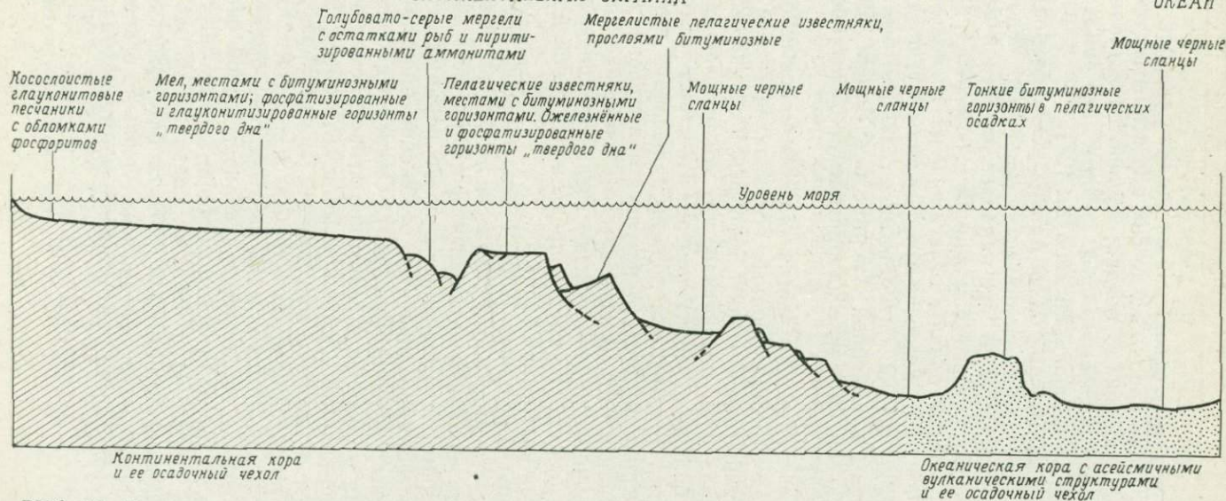
РИС. 8.7. Модель океанического осадконакопления в меловом периоде во время трансгрессии, охватывавшей области ложа океана до шельфа [250].
