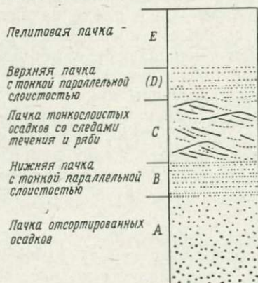
РИС. 3.13. Интерпретация турбидитного цикла Боумы как комплекса отложенных замирающего потока [490]. (См. также: А. Н. Bouma, Sedimentology of some flysch deposits: a graphic approach to facies interpretation, Amsterdam, Elsevier, 1962, 168 p.)
