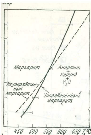
Рис. 5. Расчетные кривые реакции разложения маргарита, иллюстрирующие эффект неупорядоченности Al—Si в этой фазе. Горизонтальные линии — экспериментальные пределы неопределенности по [5]
