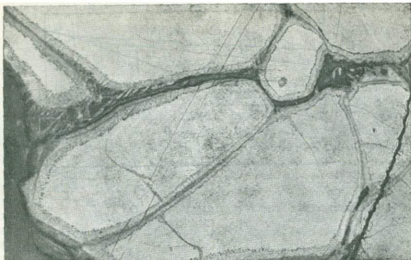
Рис. 6. Избирательное замещение зерна Pd_3Sn фазами Pd_2Sn (каемки) и SnO_2 (по трещинам в центре) в моновариантной реакции (2). Буфер Ti-TiO_2 . Полир. шлиф, увел. 100
