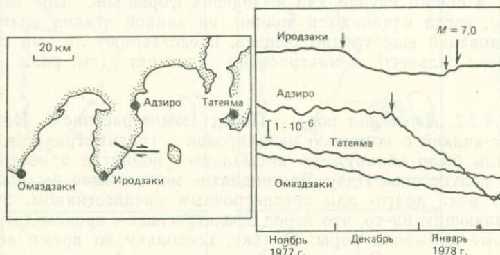
Рис. 13.18. Изменения деформации во времени, наблюдавшиеся с помощью объемных деформографов системы Сакса — Эвертсона в четырех пунктах вокруг очаговой области землетрясения Идзу — Осима-кинкай 1978 г. [44].
