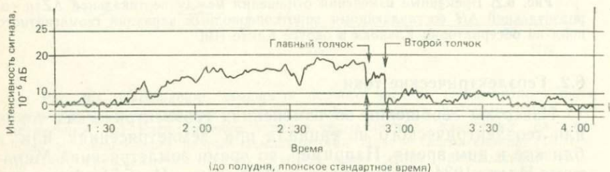
Рис. 6.3. Уровень электромагнитного излучения на частоте 81 кГц до и после землетрясений (главный толчок: M=6,1 , время 2:54:03, координаты 35^{\circ}31' с. ш., 140^{\circ}35' в. д., глубина 80 км; афтершок: M=5,3 , время 2:59:48, координаты 35^{\circ}33' с. ш., 140^{\circ}10' в. д., глубина 70 км), происшедших близ Токио 25 сентября 1980 г. Наблюдения проводились на приемной станции Сугинами в западном пригороде Токио [4].
