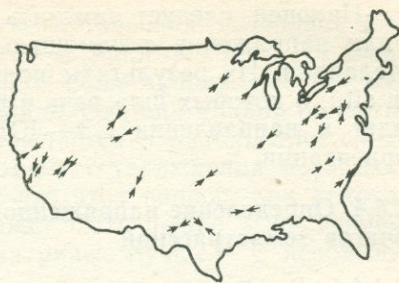
Рис. 49. Направления максимального горизонтального главного напряжения континентальной части США, определенные по ориентировке гидравлических ударов. По Хеймсону [243]
