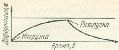
Рис. 69. Диаграмма нагрузки — разгрузки тела Кельвина. По Рейнеру [62]
