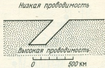
Рис. 60. Схематический разрез электропроводности под Японией. По Рикитакэ [338]
