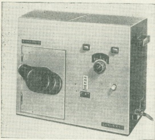
Рис. 68. Рентгеновская установка для отличия алмаза от его имитаций (GAAJ).
