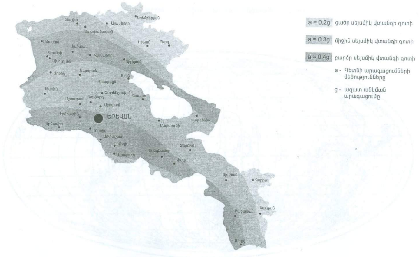
Նկ. 1.14ա Հայաստանի Հանրապետության սեյսմիկ շրջանացման քարտեզը ըստ սեյսմակայուն շինարարության ազգային ՀՀՇՆ II-2.02-94 նորմերի:
