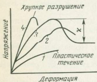
Рис. 135. Характерные кривые напряжение — деформация грунтов с различными характеристиками основной грунтовой массы при определении их прочности в режиме контроля напряжений (по Д. Тролопу и С. Чэну):
