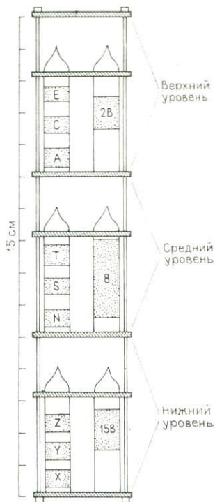
Рис. 1. Типичная геометрия закладки образцов и мониторов для облучения в реакторе TRIGA Геологической Службы США (шт. Денвер).
