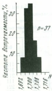
Рис. 36. Гистограмма распределения показателей преломления ( Ng' ) моноклиных пироксенов, включенных в оливин из кимберлита трубки Удачная ( n — количество измерений)
